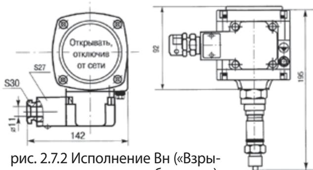
рис. 2.7.2 Исполнение Вн («Взрывонепроницаемая оболочка»). Остальное см. рис. 2.7.1
