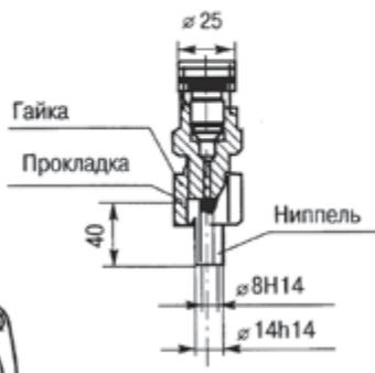
рис. 2.7.4 Размеры для КМЧ НЗ3. Остальное см. рис. 2.7.1; 2.7.2; 2.7.3
